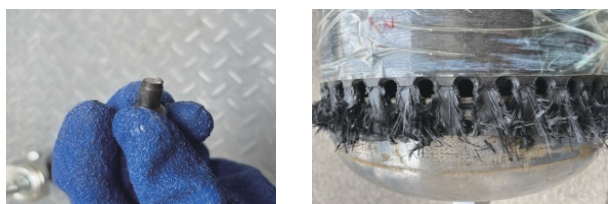
图11 5#压力容器破坏情况
