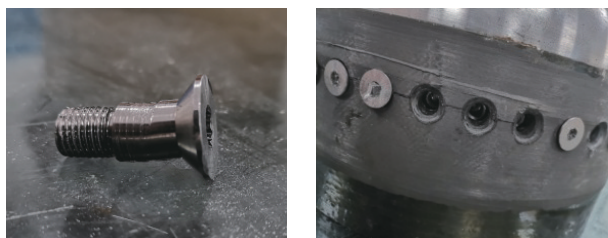
图9 3#压力容器破坏情况
