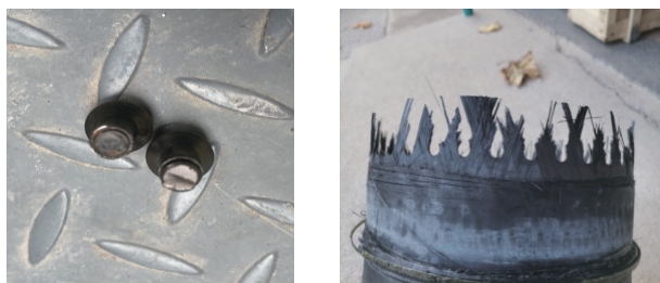
图10 4#压力容器破坏情况
